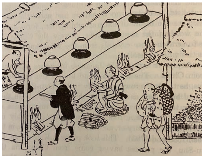
Abb. 3: Gewinnung von Campher mit der altertümlichen „bowl method“ – Kopie einer japanischen Illustration aus dem Jahr 1754 (Guenther 1950).
